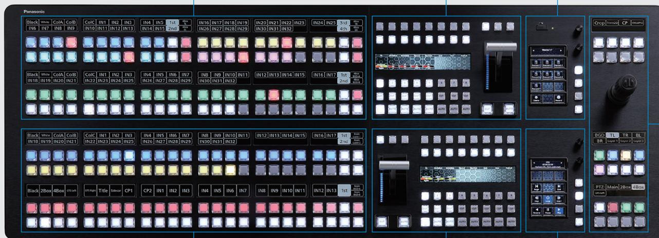
シーンコントロールブロック(ボトム)      トランジションコントロールブロック(ボトム)      マルチセレクトパネルブロック(ボトム)
