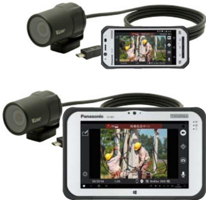
作業者が身に着けた USB カメラ<sup>※1</sup> の撮影映像を遠隔地へ配信・記録するアプリケーションソフトウェア。ウェアラブルカメラ ライブキャストをカメラ側端末 (Windows タブレット<sup>※2</sup> や Android 端末<sup>※2</sup>) にインストールして USB カメラ<sup>※1</sup> に接続。撮影した映像は、ウェアラブルカメラ ライブビューアをインストールしたモニタリング側端末 (Windows PC や Android 端末) でリアルタイムに確認することが可能です。
