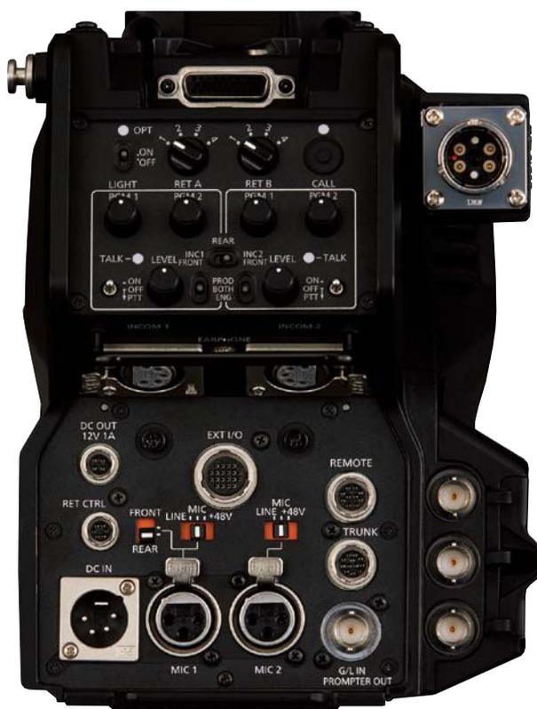
※写真は海外モデルです。国内モデルは MIC1/MIC2 端子が 3 ピンオス、INTERCOM1/INTERCOM2 端子が 4 ピンになります。
