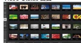
全入力、全出力、ME・DSK・AUXのバス系統、マルチビュー画面の映像素材を一覧で表示します。
