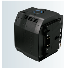
V-RAW2.0レコーダー AU-VCXRAW2 【RAID 扱い】 本体希望小売価格 2,880,000円 (税抜) ※為替により変更となる場合があります。 4K解像度で120fpsの非 圧縮RAW信号が記録できる V-RAW2.0レコーダー。
