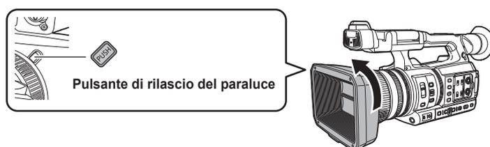
**1** Mentre si preme il pulsante di rilascio del paraluce, ruotare il paraluce stesso nella direzione della freccia per rimuoverlo.
