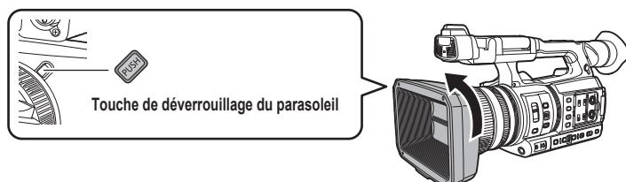
**1** Tout en appuyant sur la touche de déverrouillage du parasoleil, faites tourner le parasoleil dans la direction de la flèche pour le retirer.
