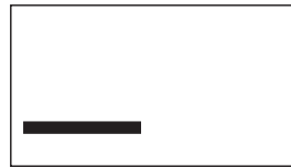
La barre s'allonge vers la droite lorsque le viseur est en mise au point.
