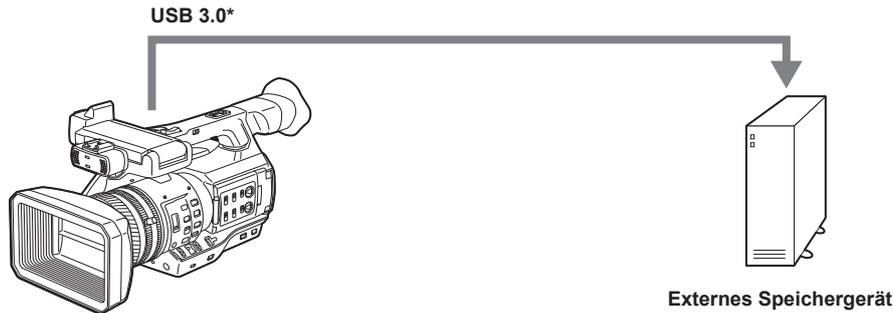
\* Das USB 3.0-Kabel ist nicht im Lieferumfang des Produkts enthalten. Verwenden Sie ein handelsübliches USB 3.0-Kabel (mit doppelter Abschirmung zur Rauschunterdrückung).
