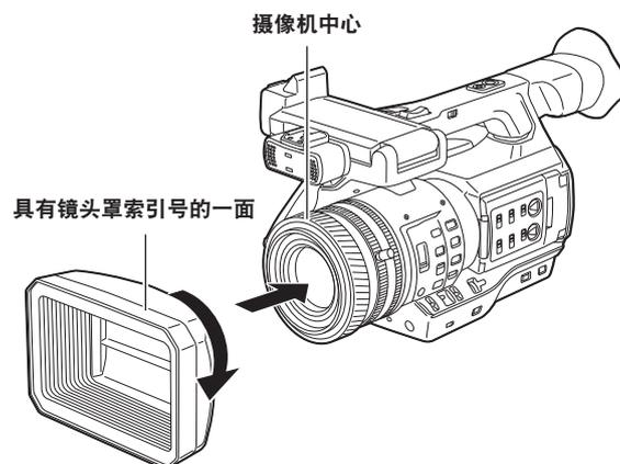
1 将镜头罩的索引号与摄像机机身的中心对齐，然后安装。
