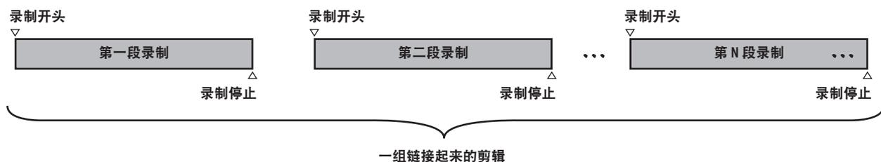
\* 最多可链接 99 段录制内容。当第 99 段录制结束后，剪辑间的链接自动结束，下一次读入的内容将自成为一段信剪辑。
