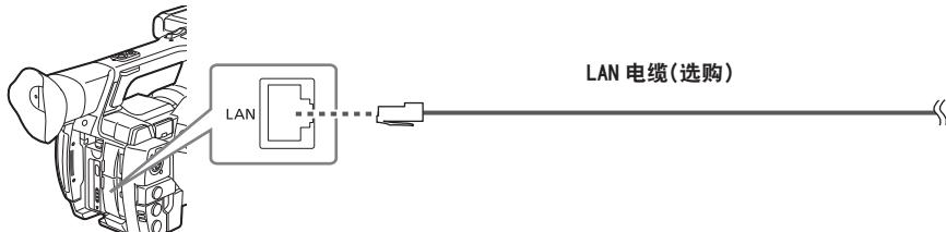
**1 将 LAN 电缆连接到背面的〈LAN〉端子。**
