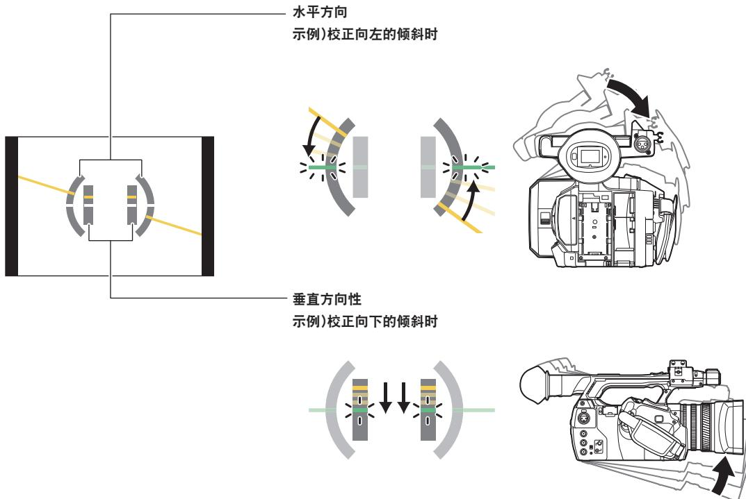
出现倾斜时，将会显示多条橙色线。几乎不存在倾斜时，橙色线将变为绿色线。可显示的水平方向倾斜度最多为 $\pm 45^\circ$ ，可显示的垂直方向倾斜度最多为 $\pm 30^\circ$ 。
