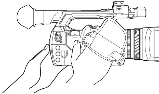
1 打开固定盖，调节腕带的长度。
