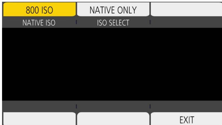
[NATIVE ISO]/[800BASE ISO]/[2500BASE ISO]/[GAIN SELECT]: отображается экран VIEW, и можно настроить параметр EXPOSURE INDEX (усиление).
