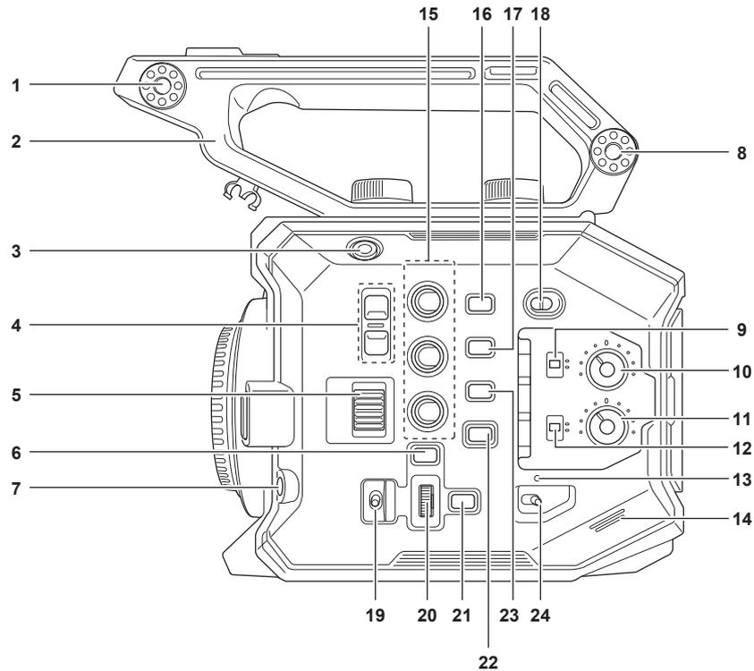
**1 Sección de montaje de la unidad de monitor LCD**
