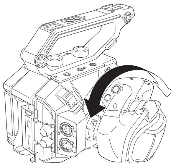
Palanca de rotación del asa
