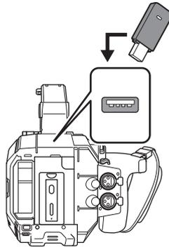
**1** Abra la cubierta del terminal para <USB2.0 HOST> situada en la parte posterior.
