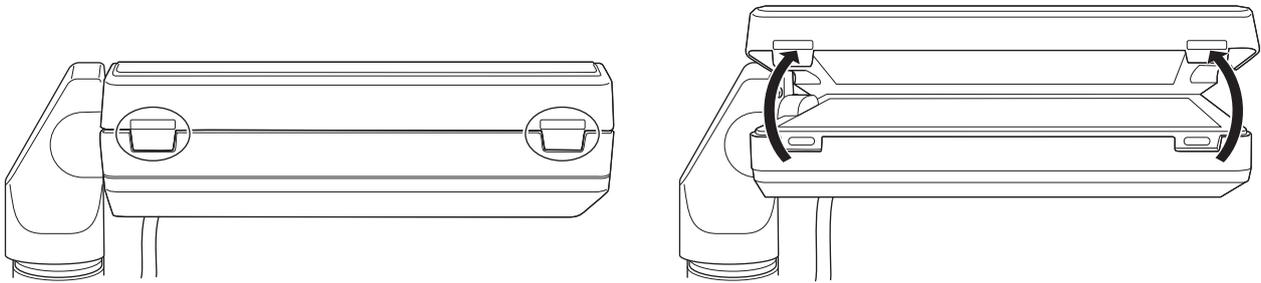
**1** Retire el parasol del monitor LCD a la vez que empuja con las uñas insertadas en los huecos de las pestañas (2 ubicaciones) en la parte superior del parasol del monitor LCD.
