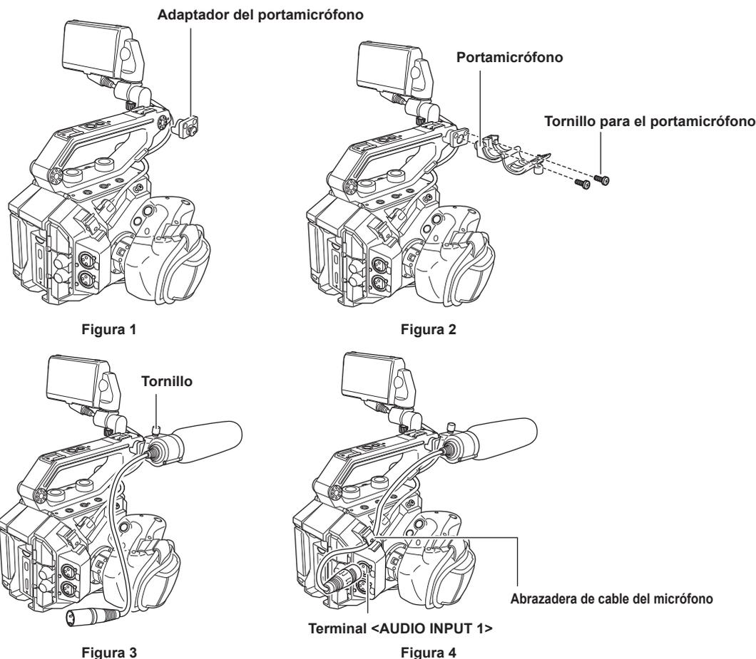
**1** Monte el adaptador del portamicrófono suministrado en la sección de montaje del micrófono de la cámara. (Figura 1)
