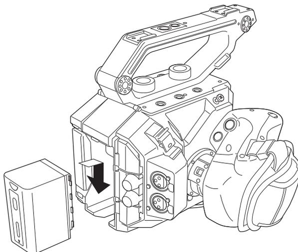
**1** Presione la batería contra la sección de montaje de la batería de la cámara y deslícela hacia abajo.
