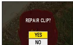
Sélectionnez YES pour lancer la réparation. Une fois la réparation terminée, "REPAIR FINISHED" s'affiche et la caméra permute sur l'écran de pause d'enregistrement. Sélectionnez NO pour permutter directement sur l'écran de pause d'enregistrement sans réparer la carte.
