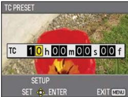
Sur cet appareil, la valeur de code temporel s'ajuste en fonction du format et de la vitesse de défilement. Pour cette raison, n'oubliez pas que la modification du format ou de la vitesse de défilement peut causer une discontinuité après la dernière valeur de code temporel de l'enregistrement précédent. (Uniquement lorsque SYSTEM FREQ est réglé sur 59,9 Hz)
