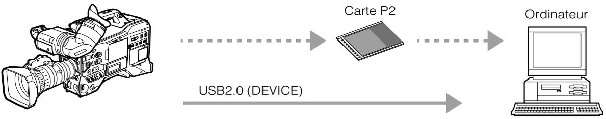
Utilisation du mode USB HOST pour raccorder un dispositif externe via le connecteur USB 2.0 (page 160)
