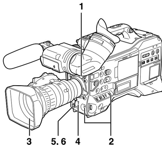
**1** Utilisez le contrôle ND FILTER pour sélectionner un filtre en fonction de la lumière ambiante.
