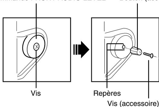
Retirez la vis au centre de la commande FRONT AUDIO LEVEL puis fixez le bouton accessoire à l'aide de la vis (fournie). Lors de la fixation du bouton, assurez-vous d'aligner les repères de la commande avec les repères du bouton.
