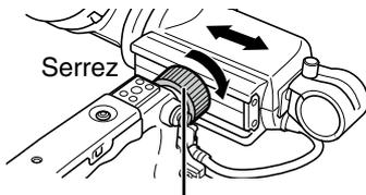
Bague de positionnement gauche-droite du viseur
