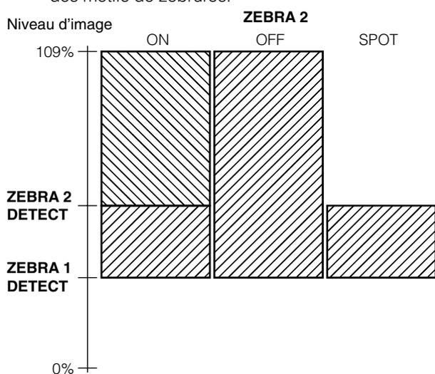
Pour afficher les motifs de zébrures sur la sortie vidéo émise par le connecteur VIDEO OUT, effectuez les réglages nécessaires sur l'écran OUTPUT SEL.
