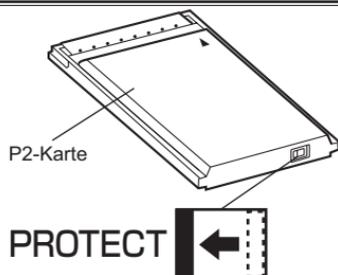
Um das Überschreiben und Löschen von Daten bei Verwendung eines Speicherkartenadapters (AJ-P2AD1) zu verhindern, stellen Sie den Schreibschutzschalter an der Speicherkarte ein, die in den Adapter eingelegt ist.
