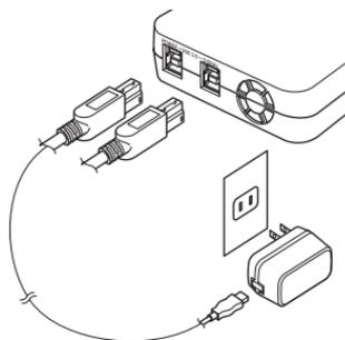
Per il collegamento dell'unità P2 sono necessari due cavi USB.
