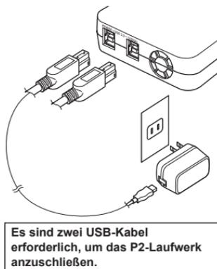
Es sind zwei USB-Kabel erforderlich, um das P2-Laufwerk anzuschließen.
