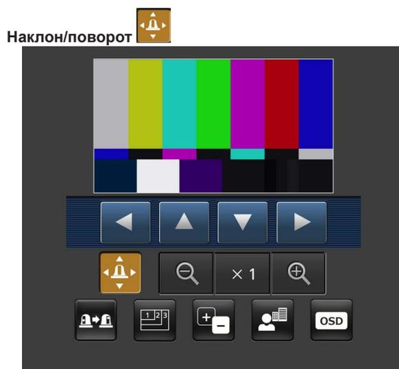
При нажатии данной кнопки на экране будут отображены кнопки, используемые для выполнения операций наклона/поворота.
