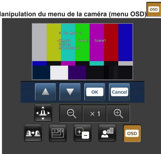
Quand ce bouton est actionné, les commandes servant à manipuler le menu de la caméra s'affichent sur l'écran. En même temps, les menus de la caméra s'affichent sur les images de l'appareil.
