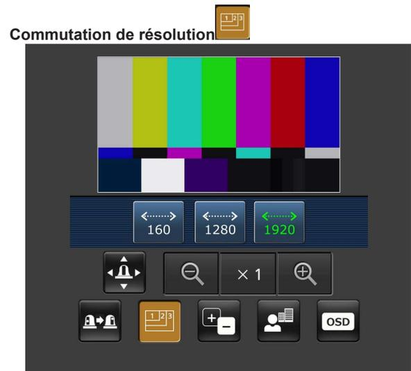
Quand ce bouton est actionné, les commandes servant à sélectionner la résolution s'affichent sur l'écran.
