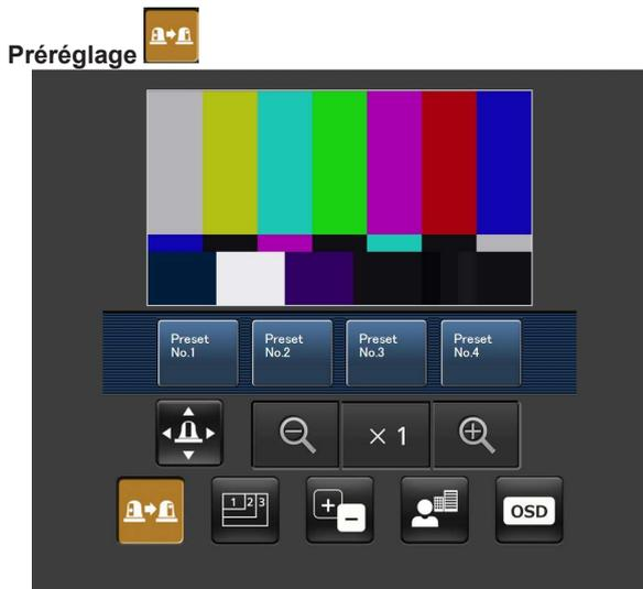
Quand ce bouton est actionné, les commandes servant à sélectionner les positions préréglées s'affichent sur l'écran.
