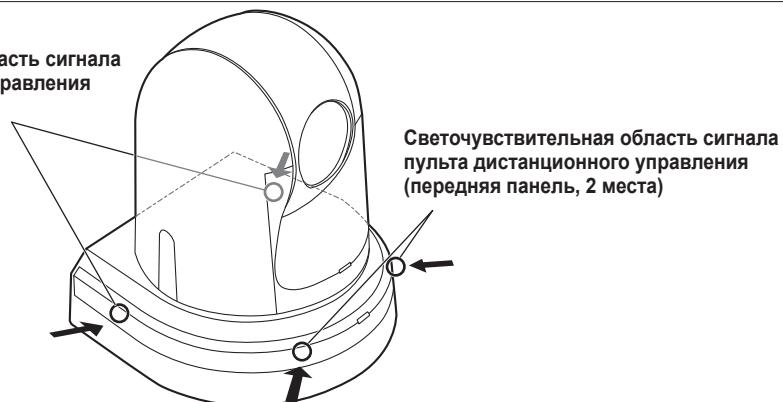
Светочувствительная область сигнала пульта дистанционного управления (передняя панель, 2 места)
