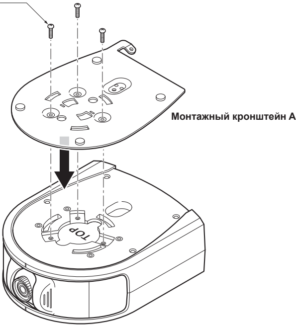
Крепежные винты В для кронштейна (М3 х 6 мм)
